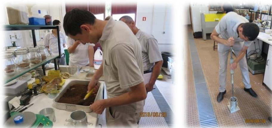
9-расм. Грунтларни оптимал зичлигини снқлаш жараёни
