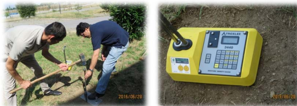
10-расм. Nuclear density gauge қурилмаси ёрдамида грунтнинг зичланганлик даражасини аниқлаш жараёни
