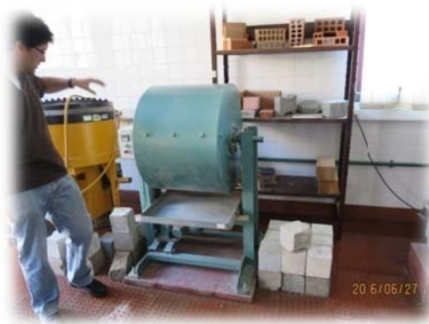
3- расм. Los Angeles Abrasion Machine қурилмаси.
